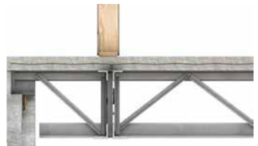
Ferme sur mur de béton
