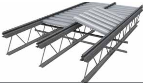
3- Panneaux de tablier métallique
