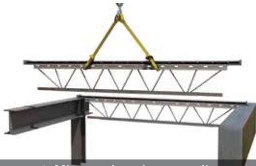
1- Mise en place des poutrelles
