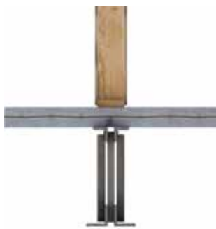
Mur porteur sur ferme
