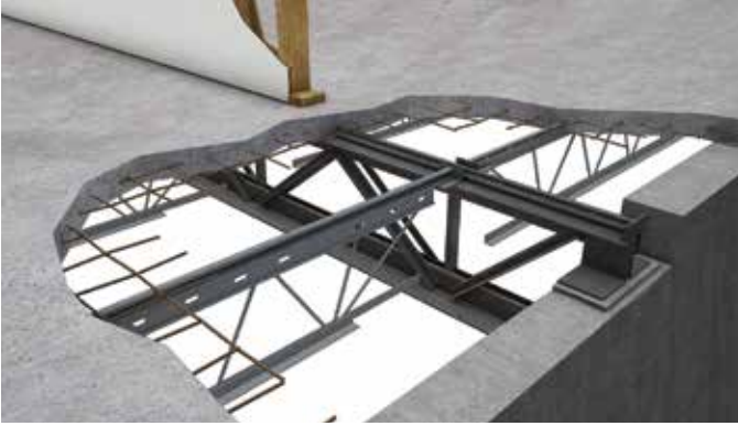
Connexion poutrelle D500 et ferme composite sur mur
