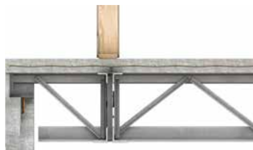
Ferme sur mur de béton
