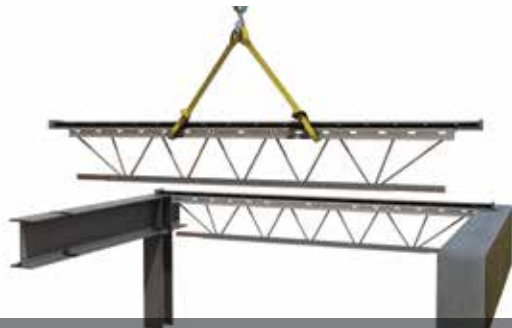
1- Mise en place des poutrelles
