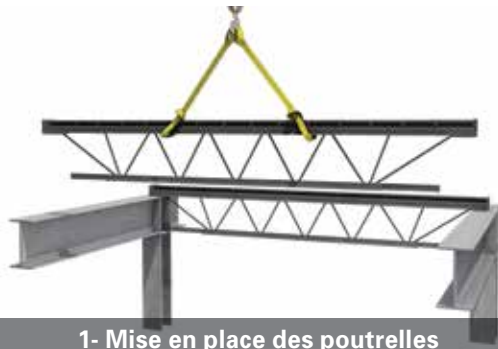
1- Mise en place des poutrelles
