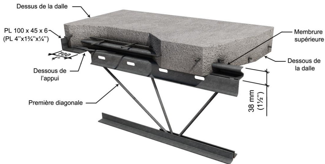
Figure 2 Siège standard d'une poutrelle Hambro D500
